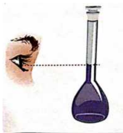
Ubicación correcta del observador con respecto al matraz.
